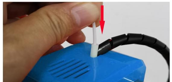
**进不了料原因: 1 耗材前端没弄直, 2 是没有一直用力压住耗材**
