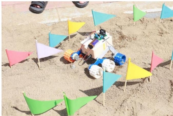
图 8 火星探测器 3D 打印+Arduino 成品
